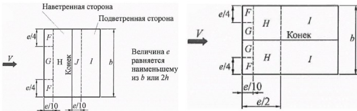
Рисунок 2 – Обозначение расчетных зон для ветровой нагрузки на двускатную крышу
