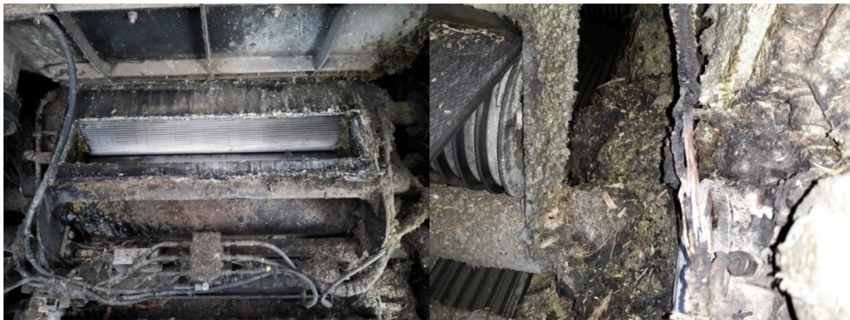
Рисунок 5 – Загрязнение доизмельчителя кормоуборочного комбайна
