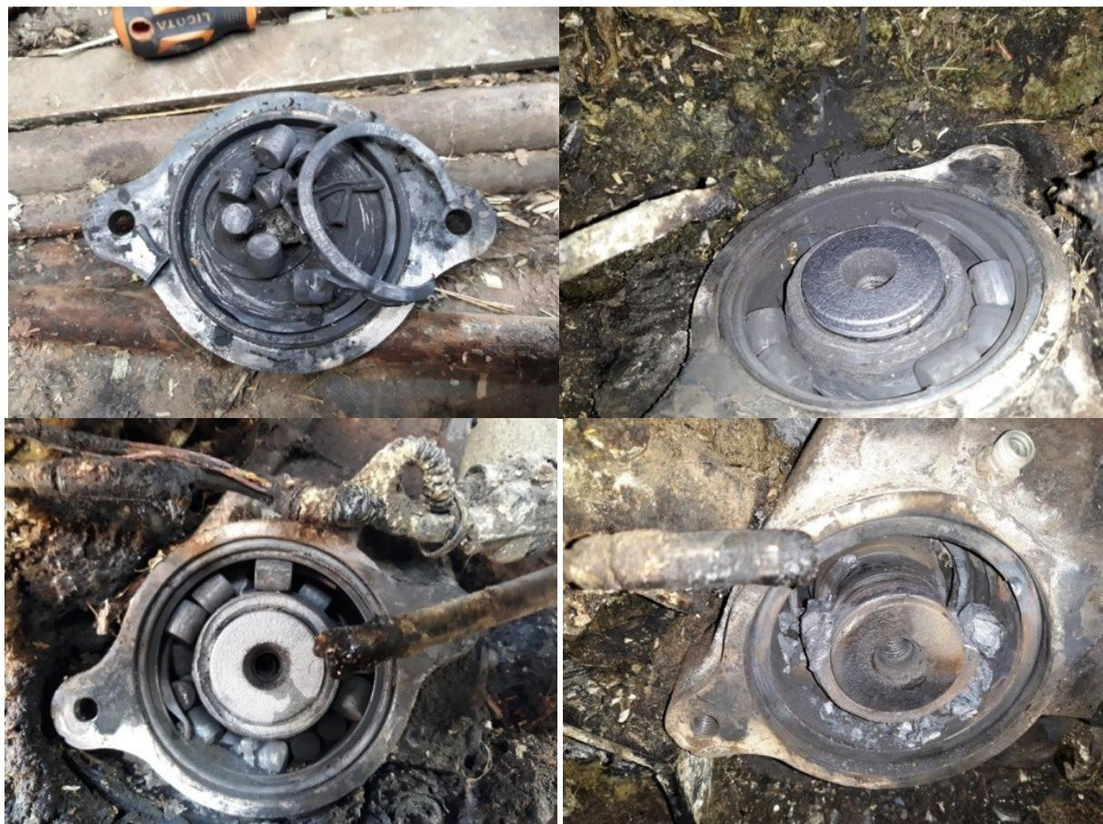
Рисунок 6 – Повреждения подшипников опоры доизмельчителя комбайна RSM 2650
