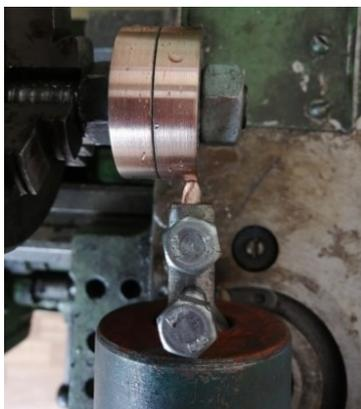
Рисунок 2 – Нанесение пленочного покрытия методом ФАБО
