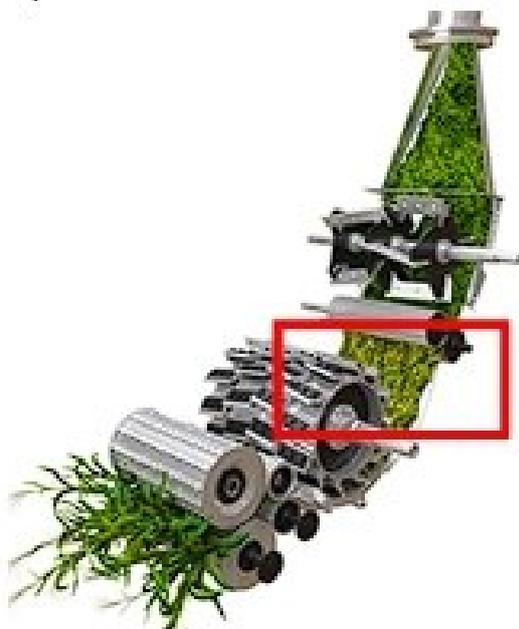
Рисунок 3 – Доизмельчитель в технологическом тракте
