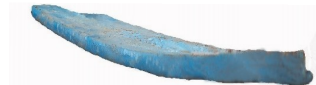
Рисунок 2 – Деформация лемеха после восстановления из-за наличия остаточных напряжений
