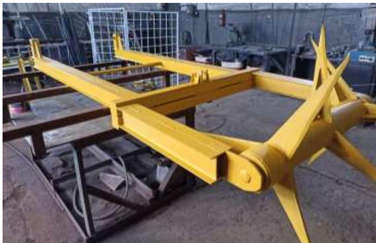
Рисунок 1 - Общий вид фронтального прокальвателя-щелереза в сборе
