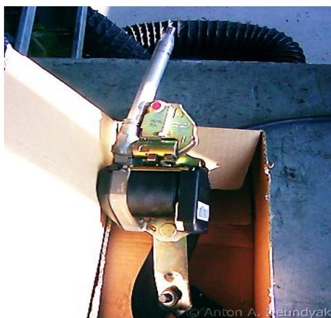
Рисунок 3.17 – Преднатяжитель ремней безопасности
