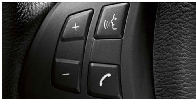
Рисунок 3.3 – Система голосового управления функциями
