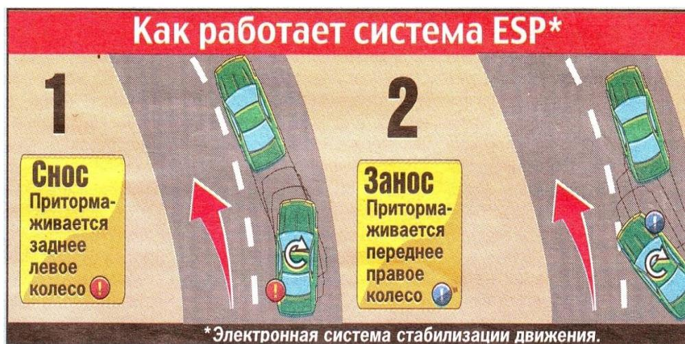
Рисунок 1.5 – Работа электронной системы стабилизации движения (ESP)
