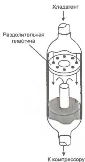
Рис. 2.24. Ресивер (отделитель жидкости)
