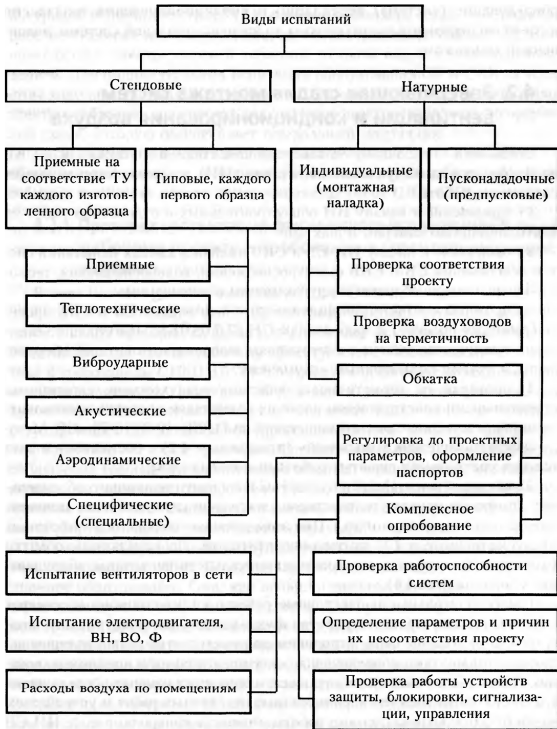
Рис 5.28. Виды основных испытаний, которые проходит оборудование (системы) СВ и СКВ от экспериментального образца до элемента реальной законченной монтажной системы: ВН — воздухонагреватель; ВО — воздухоохладитель; Ф — фильтр.
