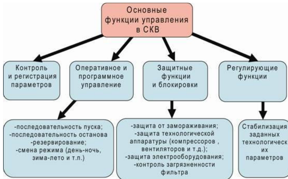
Рис. 3.1. Основные технологические функции управления СКВ.
