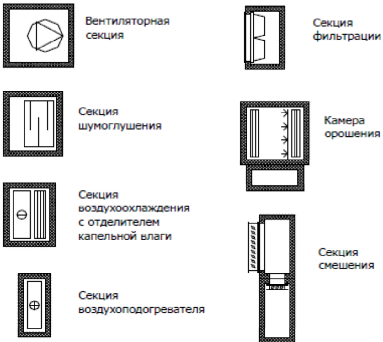
Рис. 2.5. Условные обозначения секций центральных кондиционеров
