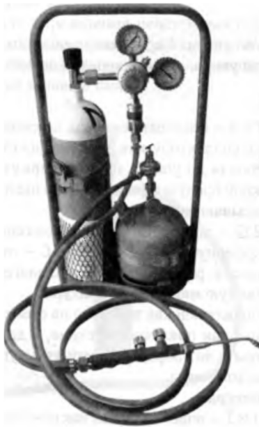
Рис. 5. Кислородно-ацетиленовый сварочный агрегат
