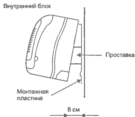
Рис. 5.28. Навеска внутреннего блока сплит-системы (начальная стадия)
