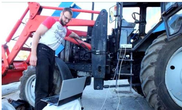
Рисунок 4 - Инженер Кирдищев Д.В. производит измерение вибрации на форсунках дизельного двигателя Д-243
