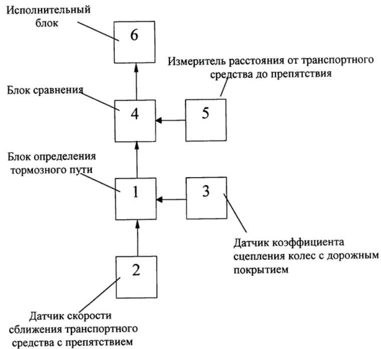
Рисунок 4.5 – Структурная схема устройства для предупреждения столкновения транспортного средства: 1 – блок определения тормозного пути; 2 – датчик скорости сближения транспортного средства с препятствием; 3 – датчик коэффициента сцепления колес с дорожным покрытием; 4 – блок сравнения; 5 – измеритель расстояния от транспортного средства до препятствия; 6 – исполнительный блок
