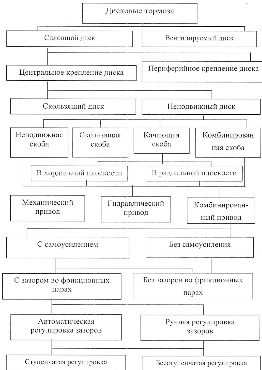
Рисунке 1.8 – Классификация дисковых тормозов
