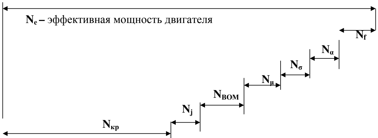
Рис.8.1. Распределение мощности двигателя на составляющие
