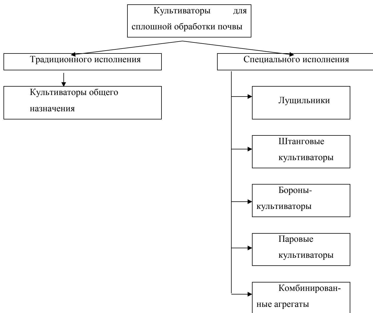
Рис.7.4. Виды культиваторов, применяемые для выполнения сплошной обработки почвы.
