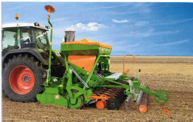
Рисунок 67 – AD-P Super, ширина захвата 3 м
