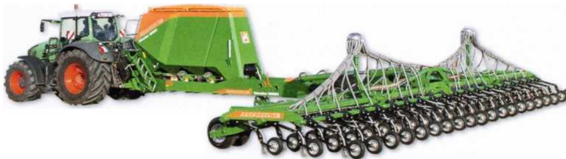
Рисунок 115 – Condor 15001: большой на поле - компактный при транспортировке с транспортной шириной 3 м
