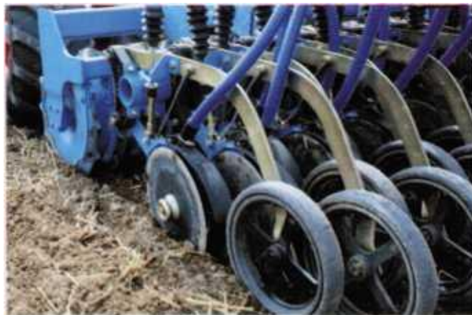
Рисунок 28 – Двухдисковые сошники ОптиДиск
