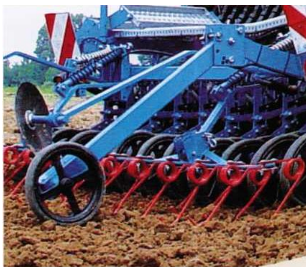
Рисунок 22 – Импульсное колесо с точным контролем скорости
