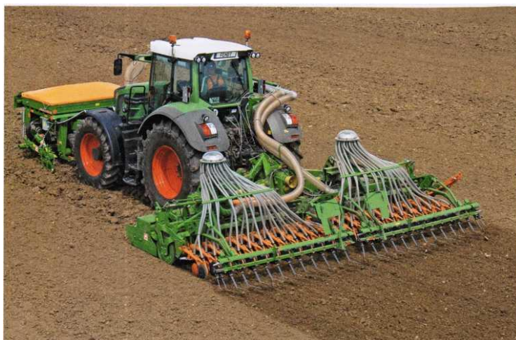
Рисунок 73 – Avant с фронтальным бункером ширина захвата-6м
