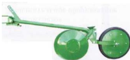
Рисунок 168 – Дисковый сошник с агрегатом для прикатывания и копирования
