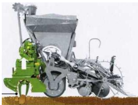
Рисунок 70 – Нагрузка на сошники только 30%
