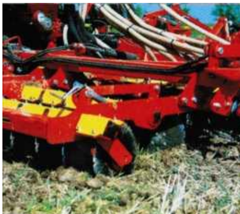
Рисунок 229 – Вид выпуклых, зубчатых дисков на упругих резиновых подвесках
