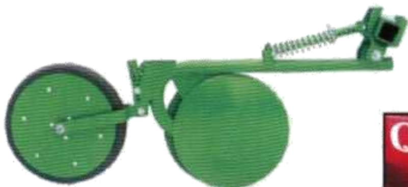
Рисунок 173 – Двухдисковые сошники (QUICK XL) с агрегатом для прикатывания и копирования (давление сошников около 40 кг)
