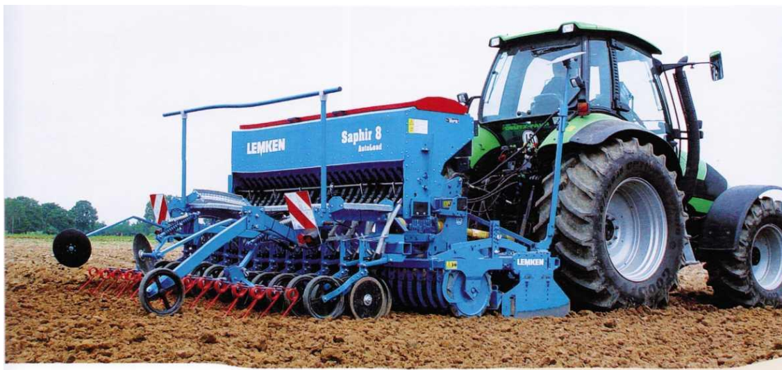
Рисунок 20 – Надежное дозирование семян электрическим приводом высевающего вала
