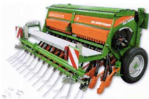
Рисунок 53 – Сеялка D9 Special с шириной захвата 3 м
