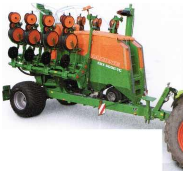
Рисунок 157 – EDX 6000-TC с компактной техникой складывания
