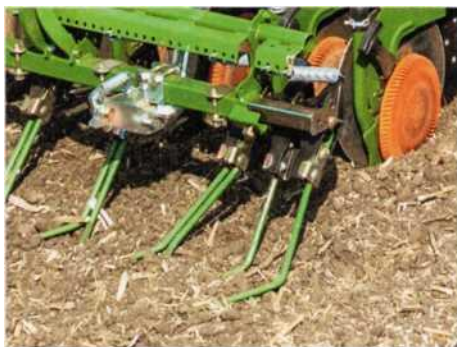
Рисунок 95 – Вид заделывающего устройства Штригель Ехакт S
