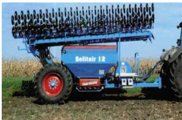
Рисунок 37 – Транспортное положение сеялки Солитэр 12
