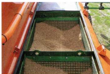
Рисунок 116 – Вид напорного бункера объёмом 8000 л разделённого на два отсека
