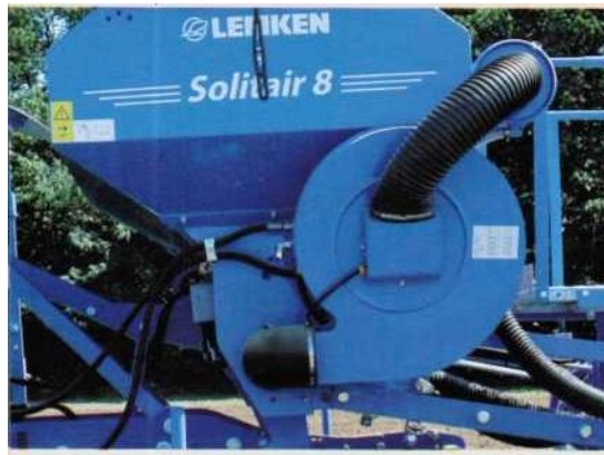
Рисунок 25 – Вентилятор с гидравлическим приводом
