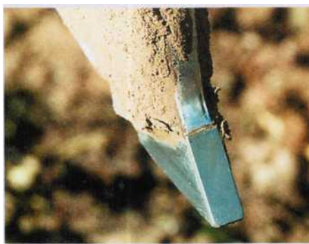
Рисунок 123 – Твёрдосплавное покрытие сошника
