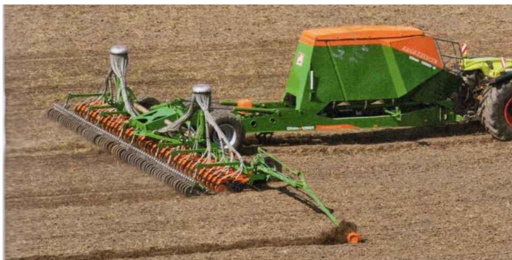
Рисунок 103 – Citan 12001-С с внесением удобрений
