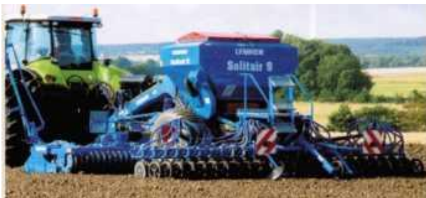
Рисунок 35 – Комбинация сеялки Солитэр с Цирконом
