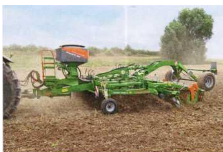
Рисунок 138 – Сеялку GreenDrill с с мульчирующим культиватором Ceni- us 4002-T Super
