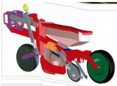
Рисунок 209 – Секция MONOPILL S для обычного сева, цепная передача и уплотняющий каток Monoflex.
