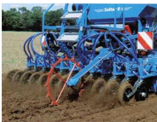
Рисунок 24 – Зубчатое колесо привода движется в рабочей ширине
