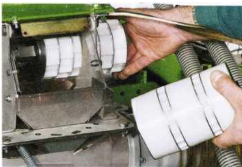
Рисунок 68– Лёгкая замена дозирующих катушек
