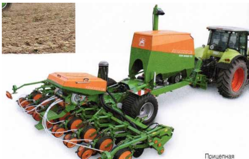
Рисунок 155 – Прицепная сеялка точного высева EDX 6000-ТС, ширина захвата 6 м
