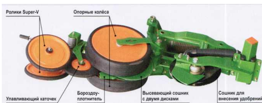
Рисунок 159 – Устройство сошниковой группы
