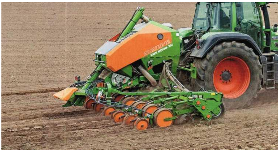
Рисунок 151 – Навесная сеялка точного высева EDX 6000-2С, ширина захвата 6 м
