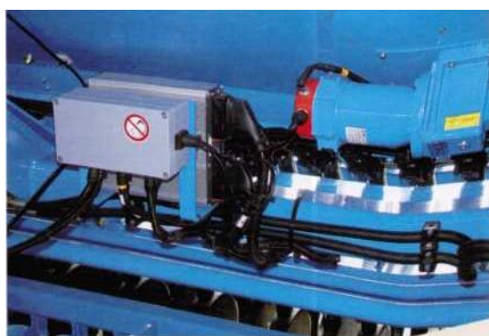
Рисунок 21 – Электрический привод высевяющего вала с точным дозированием
