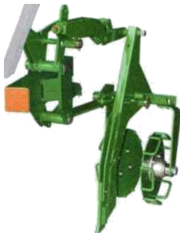
Рисунок 122 – Секция с долотовидным сошником
