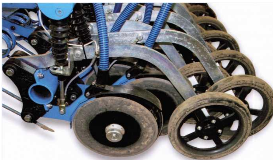
Рисунок 49 – Двухдисковой сошник OptiDisc с сенсором для регистрации давления на ролик контроля глубины
