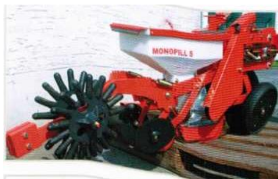
Рисунок 210 – Секция MONOPILL S для мульчированного сева, цепная передача и пальчиковый уплотняющий каток.
