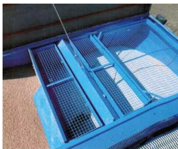
Рисунок 41 – Изменяющийся раздельный бункер Компакт-Солитэра HD
