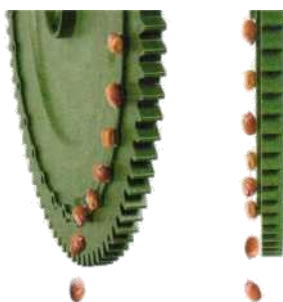
Рисунок 142 – Вид процесса укладки семян в борозду
