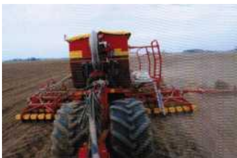
Рисунок 221 – Вид интегрированной центральной прикатывающей опоры сеялки Rapid A 600С
