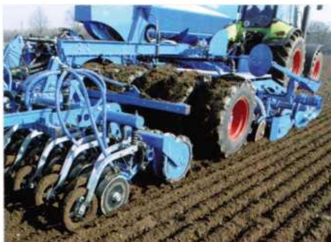
Рисунок 44 – Рабочие органы Компакт-Солитэра 9/600 КНД
