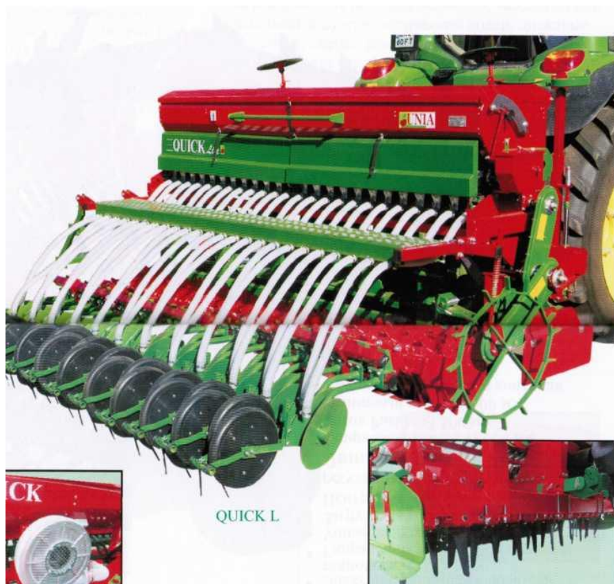
Рисунок 172 – Вид возделывающе-посевного агрегата QUICK L, XL ACTIVE и его узлов
