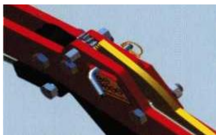
Рисунок 236 – Вид механизма регулирования глубины проникновения в почву сошников сеялки Seed Hawk
