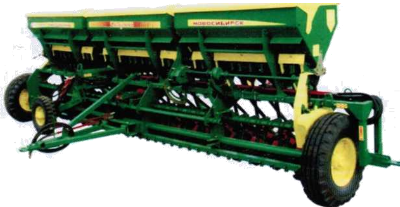
Рисунок 3 - Сеялка зернотуковая рядовая СЗР-5,4
