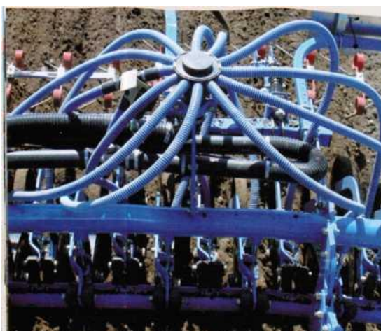
Рисунок 30 – Вид распределителя семян
