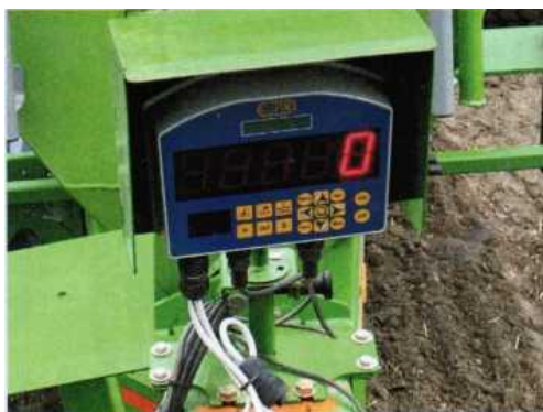
Рисунок 102 – Вид системы взвешивания на Citan 6000
