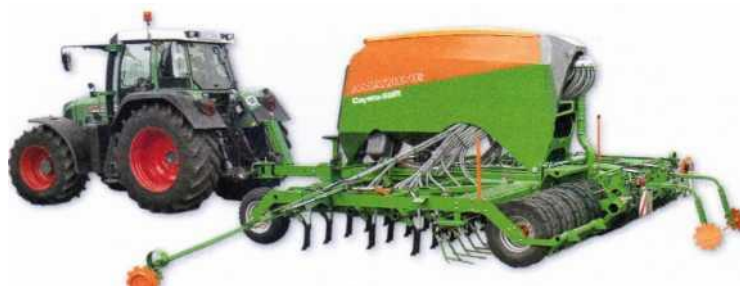
Рисунок 109 – Сауена 6001:36 долотовидных сошников, междурядье 16,6 см - рабочая скорость до 15 км/ч
