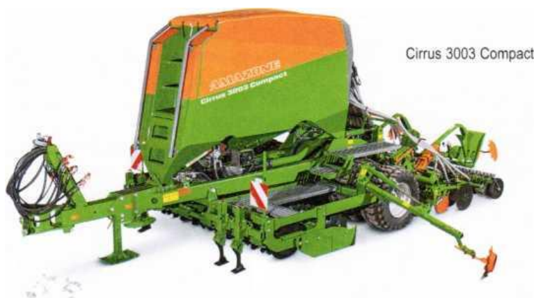
Рисунок 86 – Компоновка посевного агрегата Cirrus 3003 Compact
