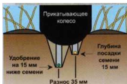
Рисунок 235 – Схема размещения семян и удобрений сеялками Seed Hawk
