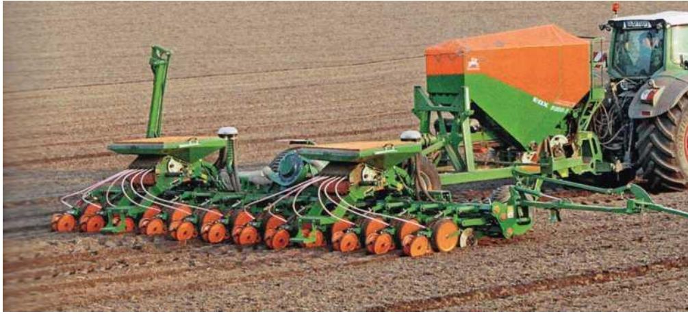
Рисунок 160 – Прицепная сеялка точного высева EDX 6000-ТС, ширина захвата 9 м
