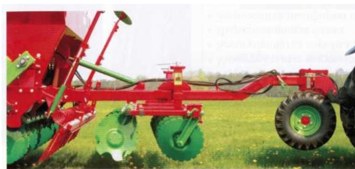
Рисунок 177 – Почвообрабатывающий модуль сеялки IDEA 3/2200
