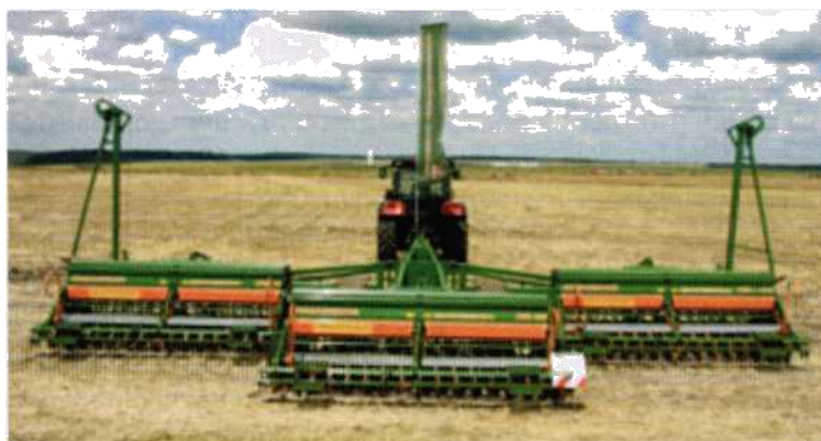
Рисунок 6 - Универсальный широкозахватный почвообрабатывающий и посевной агрегат на базе сцепки KR-12002
