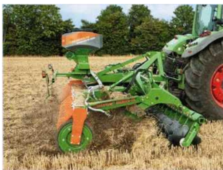
Рисунок 135 – Вид высевающего вала и турбина с сервоприводом или гидравлическим приводом
