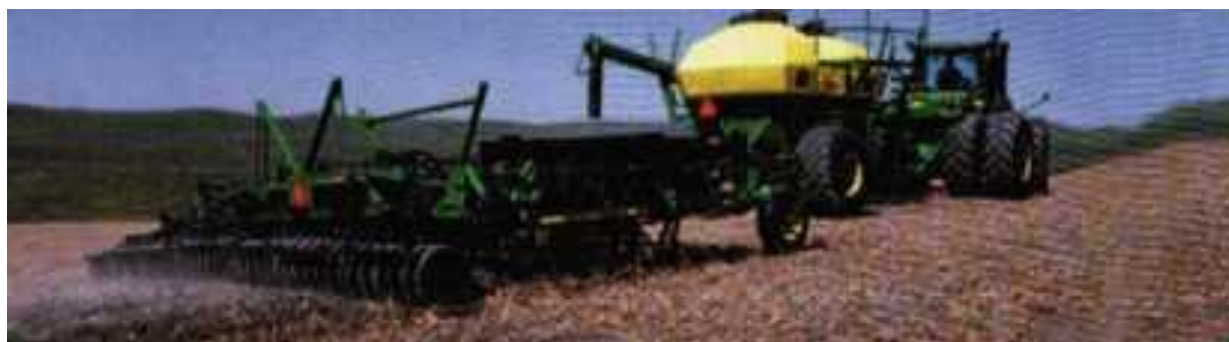
Рисунок 216 – Вид дисковой пневматической сеялки серии 730
