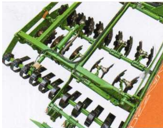
Рисунок 90 – Вид дисковой бороны с необслуживаемыми дисками
