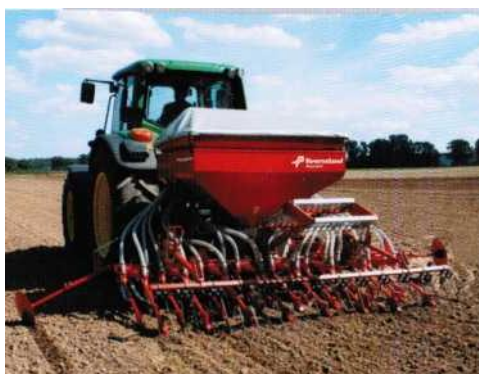
Рисунок 203 – Вид пневматической зернотравяной сеялки DL
