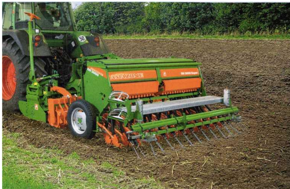
Рисунок 50 – D9 3000 Super со штригелем Ехакт в комбинации с ротационной бороной и зубчатым катком
