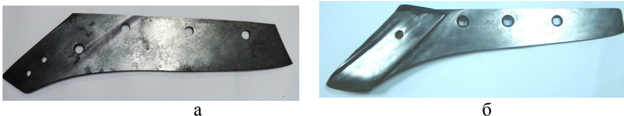
Рисунок 5 – Характерный износ режуще-лезвийной части импортных лемехов: (а - лемех фирмы «Квернеланд Групп»; б - лемех фирмы «Беллота»)
