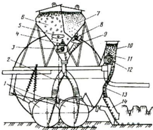
Рисунок 1 – Технологическая схема зерно-туко-травяной сеялки СЗТ-3,6
