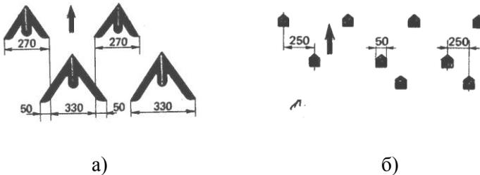
а) со стрельчатými лапами; б) с рыхлительными лапами;
