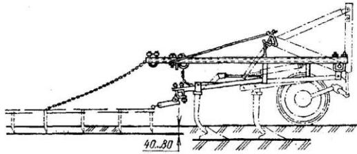
Рисунок 2 - Технологическая схема культиватора КПС- 4
