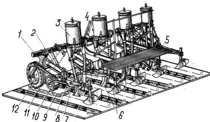
Рисунок 1-Технологическая схема пропашного культиватора КОН – 2,8ПМ
