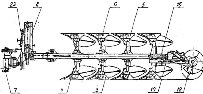
3 – корпус правооборачивающий; 4, 6 – углоснимы; 7 - навеска, 8 – механизм оборота рамы; 10 – ход колёсный; 16 – ось; 23 – цепь
