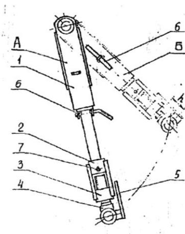
1 – направляющая; 2 – шток; 3 – гайка штока; 4 – винт; 5 – линейка; 6 – рукоятка; 7 – рычаг; А – транспортное положение; Б – рабочее положение
