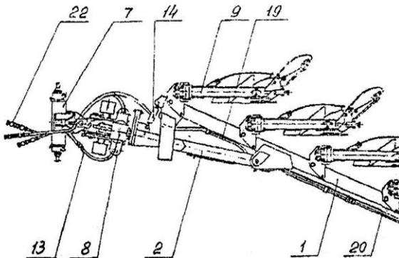
1 – рама; 2 – балка тяговая; 7 – навеска; 8 – механизм оборота рамы; 9 – предохранитель; 13 – гидросистема; 14 – талреп; 19, 20 – трубопровод; 22 – клапан запорного устройства
