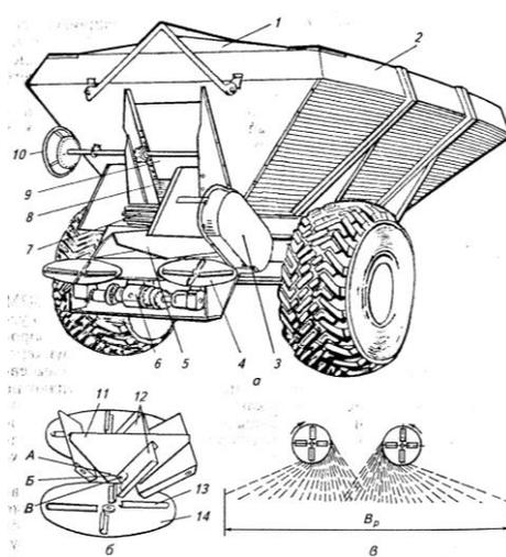
Рисунок 1 – Разбрасыватель минеральных удобрений МВУ – 6
