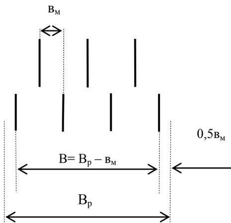
$B$  – расстояние между 1-м и 24-м сошниками;  $B_p$  – рабочая ширина захвата сеялки (3,6 м);  $B_M$  – ширина междурядья (0,15 м).
