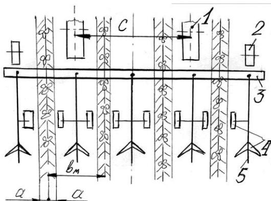
1-опорные колеса трактора; 2- опорные колеса культиватора; 3- брус-рама культиватора; 4- рабочие органы; 5-грядиля; С – колея трактора;  $в_m$ - ширина между рядья;  $a$  – ширина защитной зоны;
