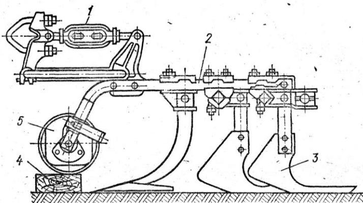
1- соединительная гайка; 2-грядиль; 3-рабочие органы; 4- деревянный брусок; 5-копирующее колесо секции
