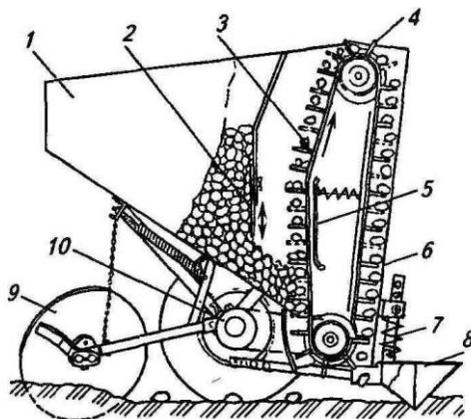
Рисунок 3 – Технологическая схема картофелесажалки Л - 201
