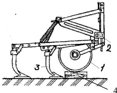
1 - колесо; 2 – навесное устройство; 3 - стрельчатая лапа; 4 - деревянный брусок
