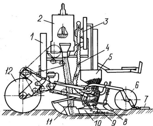
Рисунок 2 - Технологическая схема сеялки СУПН - 8
