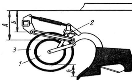
1-копирующее колесо; 2-замок; 3-опорное колесо
