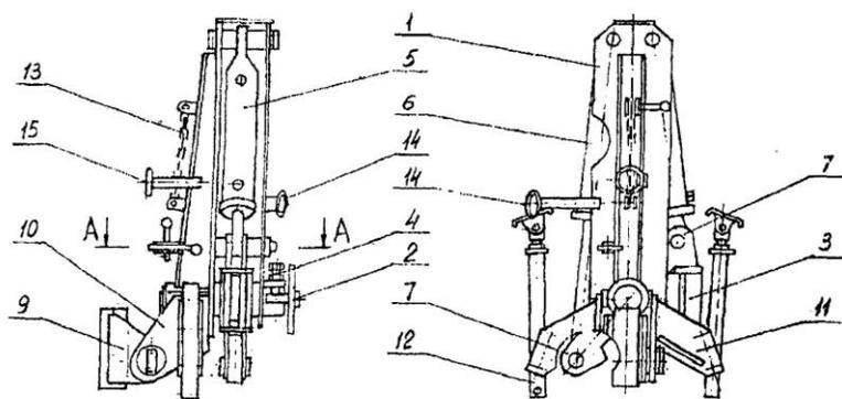
1 – корпус; 2 – вал; 3 – упор; 4 – болт регулировочный; 5,6 – гидроцилиндр; 7 – рычаг; 9 – крестовина; 10 – понизитель корпуса; 11, 14, 15 – кронштейн; 12 – опора; 13 – цепь
