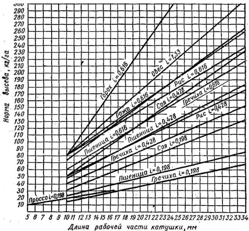
Рисунок 2 – Диаграмма ориентировочной зависимости нормы высева ( $Q$ ) от длины рабочей части катушки ( $l$ ) и передаточного отношения ( $i$ )
