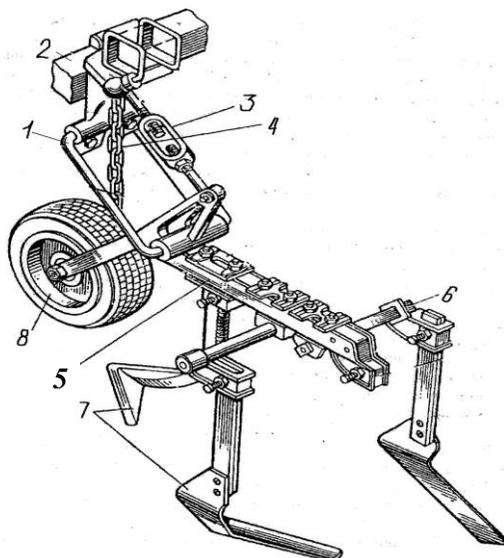
Рисунок 2 – Секция пропашного культиватора КОИ – 2,8
