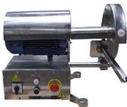
Пила предназначена для деления тушек битой охлажденной птицы на полутушки при производстве полуфабрикатов из мяса птицы на птицеперерабатывающих предприятиях. Преимущества (усовершенствованной пилы): установленная мощность двигателя - 1,1 кВт; степень защиты пилы – IPX5D; отсутствие ременной передачи и подшипникового узла; пульт управления встроен в корпус пилы; оригинальная конструкция ножа (с пазами) для улучшения качества резки птицы; более доступная зона резки; меньший уровень шума.
