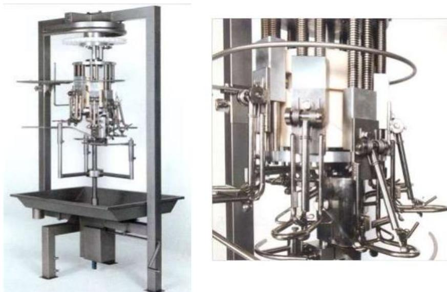
Рисунок 7.18 - Машина для разрезания брюшной полости фирмы «SAB»
