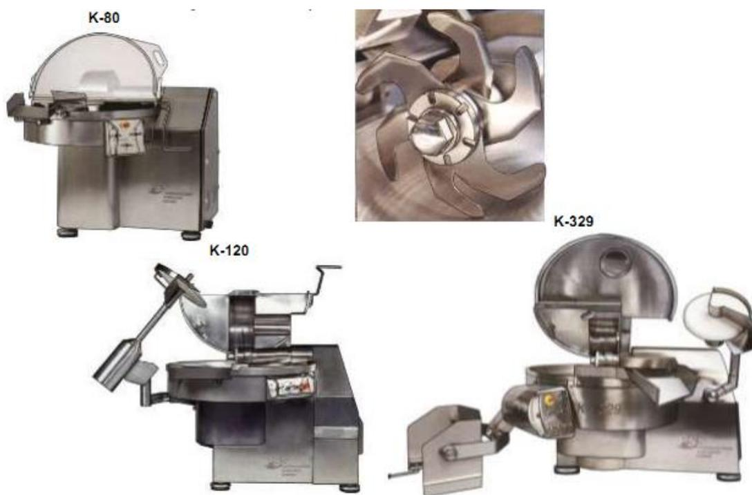
Рисунок 10.27 - Общий вид куттеров фирмы PSS (Словакия)
