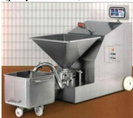
Рисунок 10.30 - Куттер «Konti» фирмы «Зайдельманн» типа «КК 250 АС 6»
