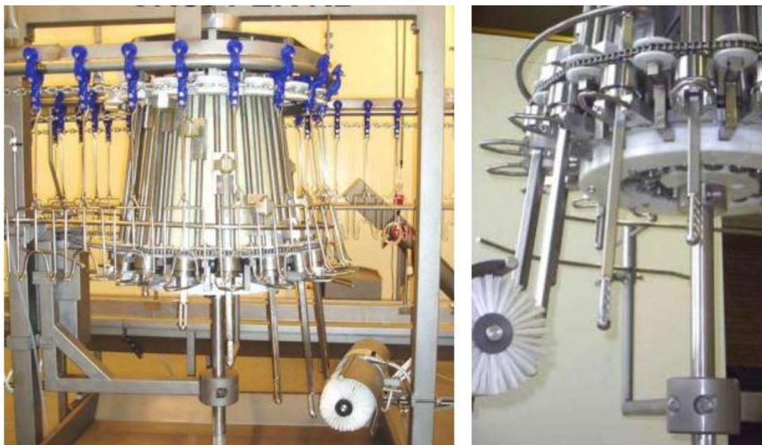
Рисунок 7.22 - Машина для удаления зоба КВ фирмы «EMF»
