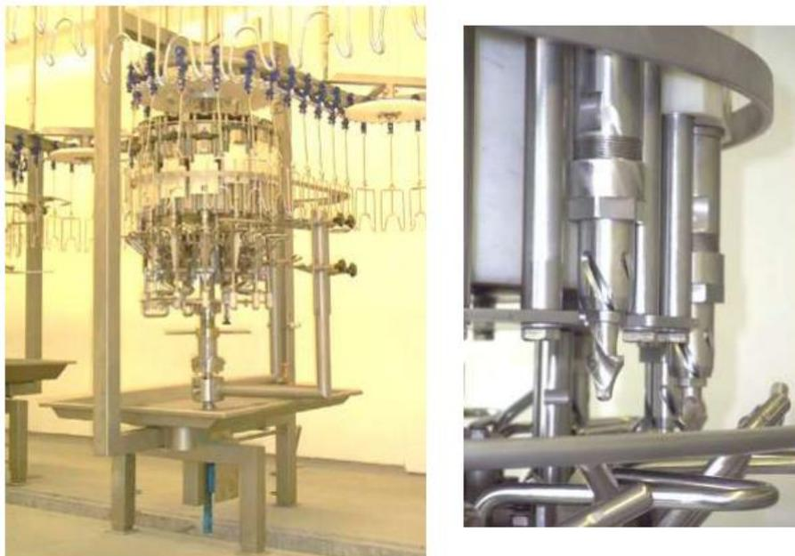
Рисунок 7.17 - Машина для вырезания клоаки KS фирмы «EMF»
