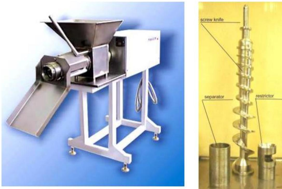
Рисунок 8. 8 - Пресс механической обвалки марки «УНИКОН»
