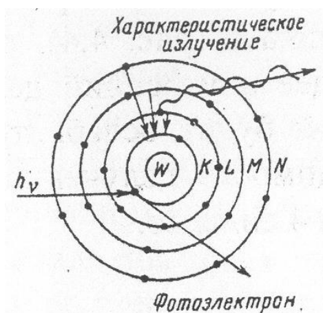
Рисунок 5 - Схема возникновения фотоэлектрона и характеристического излучения при поглощении фотона рентгеновского излучения
