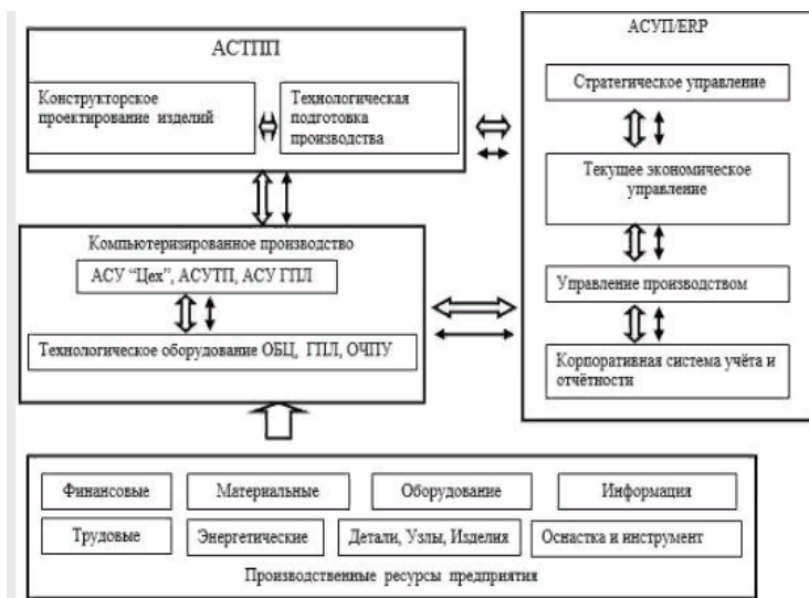
Рисунок 1 - Схема автоматизированной системы управления предприятием (АСУП)
