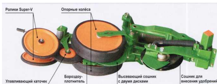
Рисунок 5.9 – Устройство сошниковой группы
