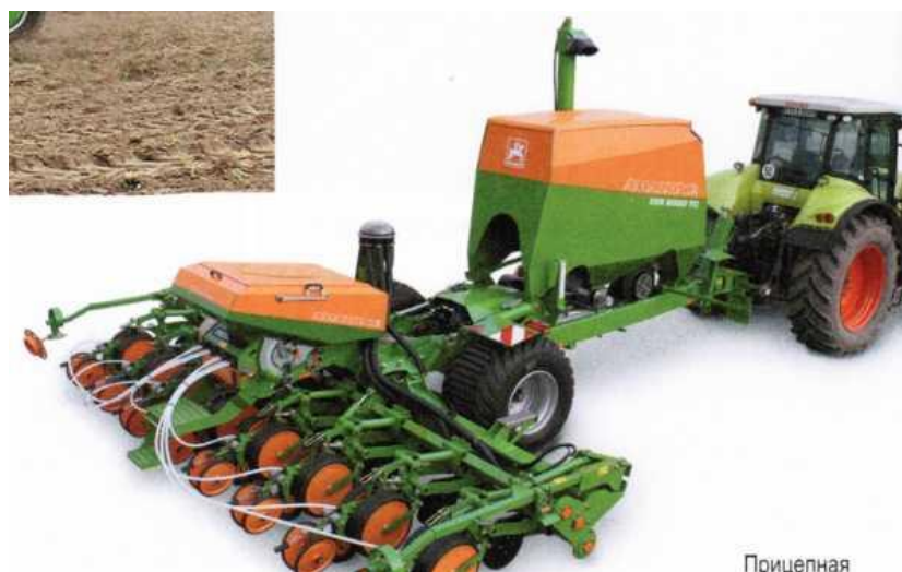
Рисунок 5.5 – Прицепная сеялка точного высева EDX 6000-ТС, ширина захвата 6 м
