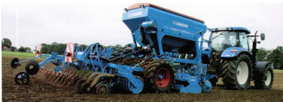
Рисунок 4.18 – Компакт-Солитер с ротационной бороней и рабочей шириной 3 метра
