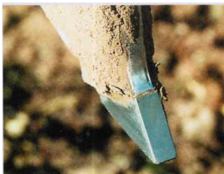
Рисунок 2.6 – Твёрдосплавное покрытие сошника
