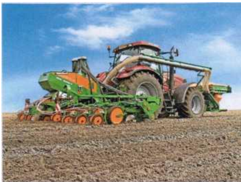
Рисунок 5.4 – Сеялка EDX 6000-2FC с фронтальным бункером для удобрений
