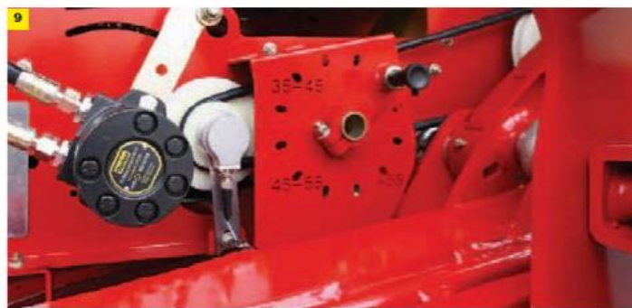
Рисунок 9.3 - Настройка высаживающего аппарата на различный размер клубней (9)
