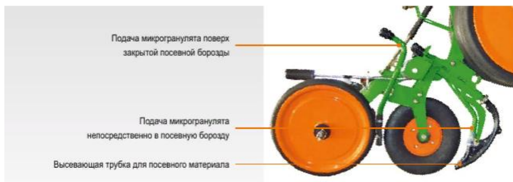
Рисунок 5.11 – Способы подачи микрогранулята
