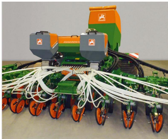
Рисунок 5.10 – EDX 6000-ТС с двумя распределителями микрогранулята
