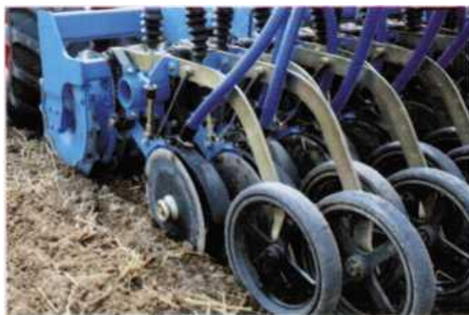
Рисунок 4.5 – Двухдисковые сошники ОптиДиск
