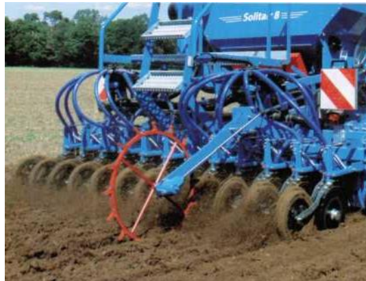
Рисунок 4.2 – Зубчатое колесо привода движется в рабочей ширине
