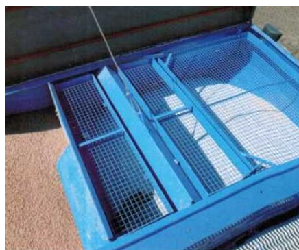
Рисунок 4.14 – Изменяющийся отдельный бункер Компакт-Солитэра HD
