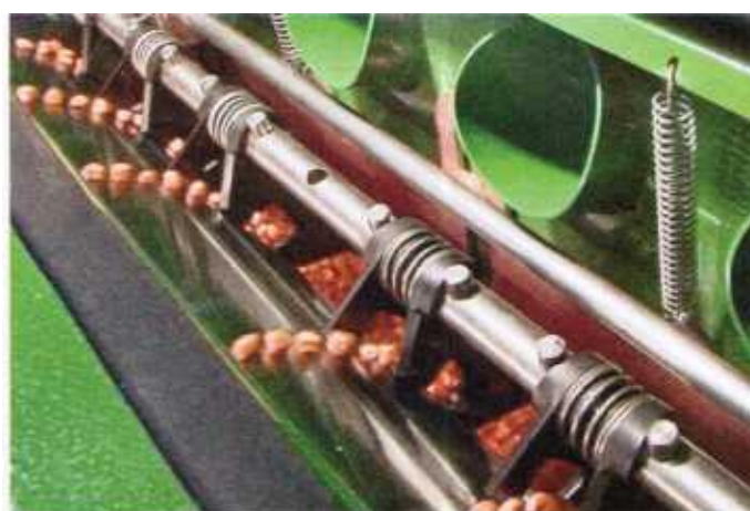
Рисунок 5.6 – Регулируемые из кабины отсекатели
