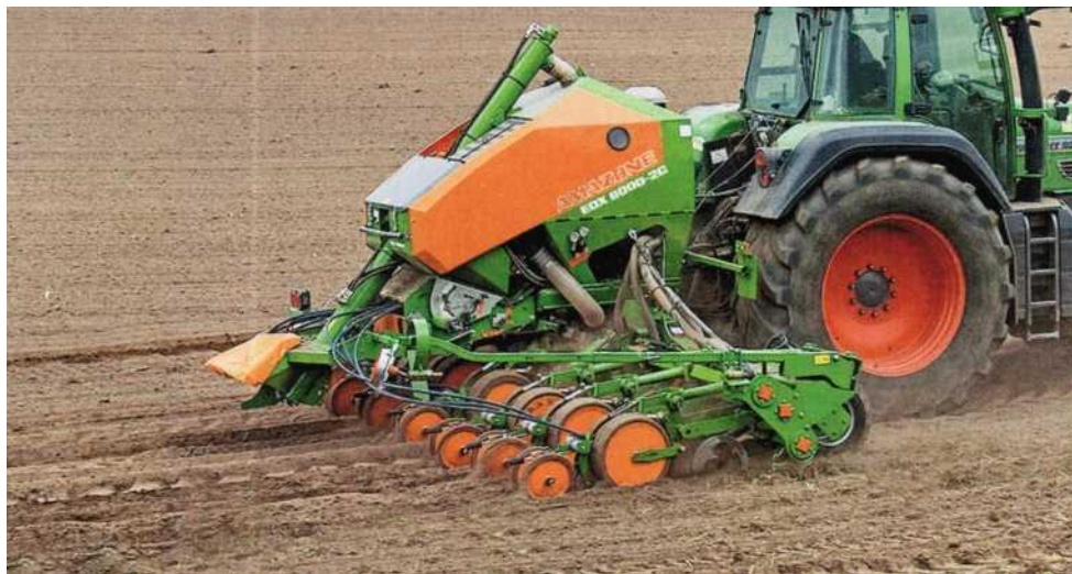
Рисунок 5.1 – Навесная сеялка точного высева EDX 6000-2С, ширина захвата 6 м
