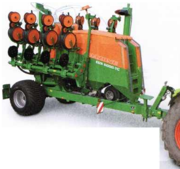
Рисунок 5.7 – EDX 6000-ТС с компактной техникой складывания
