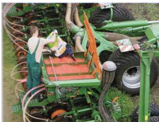
Рисунок 5.8 – Заполнение семенных бункеров
