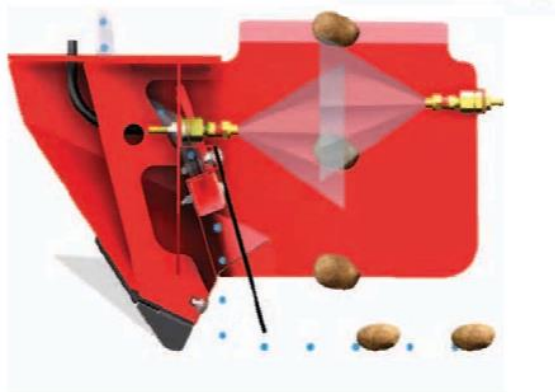
Рисунок 9.7 – Разделение жидкости системой FLOW-BOARD
