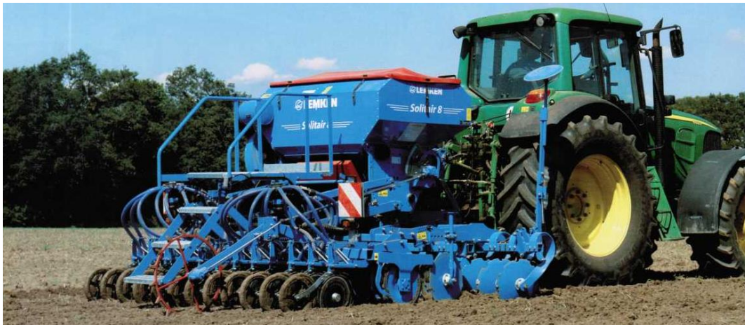
Рисунок 4.1 – Вид пневматической сеялки Солитер 8 в работе
