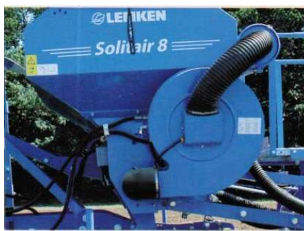
Рисунок 4.3 – Вентилятор с гидравлическим приводом
