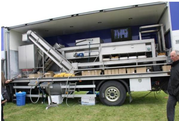
Рис. 8. Мобильная мини-линия по переработке картофеля
