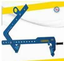
Захват боковой навесной (на тросовый подвес) для механизированной переноски и установки бордюров. Имеет регулировку по ширине захвата
