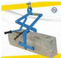
Захват поперечный навесной (на тросовый подвес) для механизированной переноски и установки бордюров весом до 150 кг. Имеет регулировку по длине захвата
