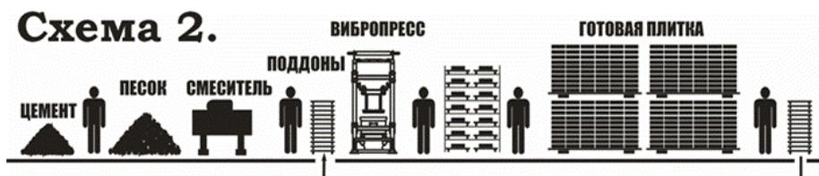
Линия по производству тротуарной плитки (по ГОСТу 17608-2017) проходит промышленным способом с применением цемента, воды и заполнителя. Есть два основных метода: вибролитье и вибропрессование смесей.
