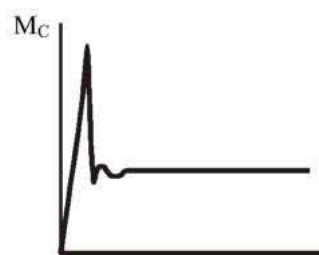
Рисунок 6.6 - Нагрузочная диаграмма тарельчатого дозатора
