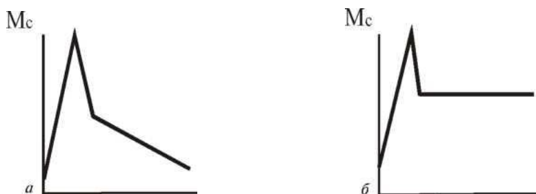
Рисунок 6.4 - Нагрузочные диаграммы барабанного дозатора при порционной (а) и постоянной (б) загрузках
