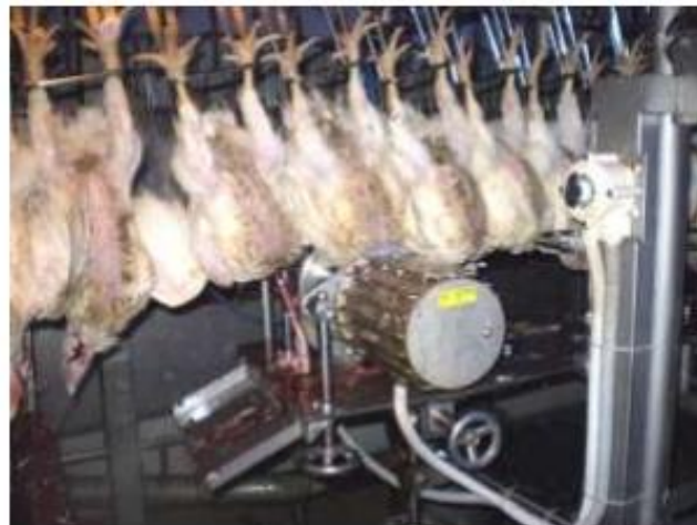
Рис. 4.2 - Автоматическая машина для убоя птицы Т8000
