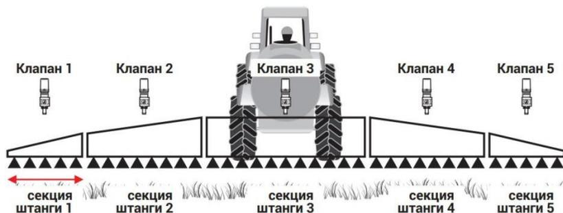
Рисунок 3 – Управление секциями опрыскивателя
