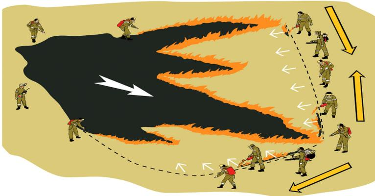
Рисунок 16 - Тушение пожара сухой травянистой растительности, действующего с образованием клиньев на фронтальной кромке, с применением ранцевых опрыскивателей, воздуходувок и отжига
