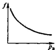
Рисунок 7- Зависимость коэффициента сопротивления качению от давления воздуха в шине
