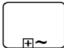
Рис. 18. Графический элемент Спонтанный Подпроцесс.
