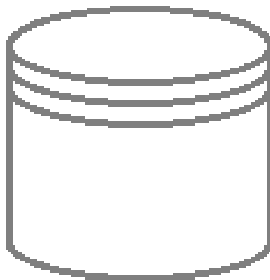
Рис. 32. Графический элемент Хранилище данных
