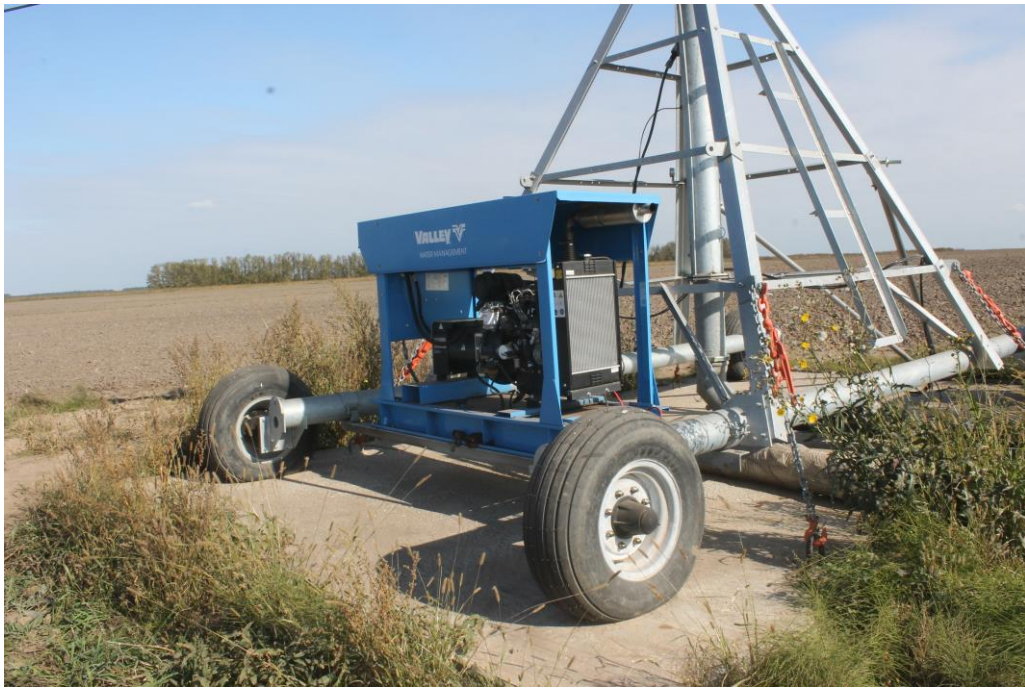
Центральная опора, дизель-генератор дождевальной машины Valley, д. Васьковичи
