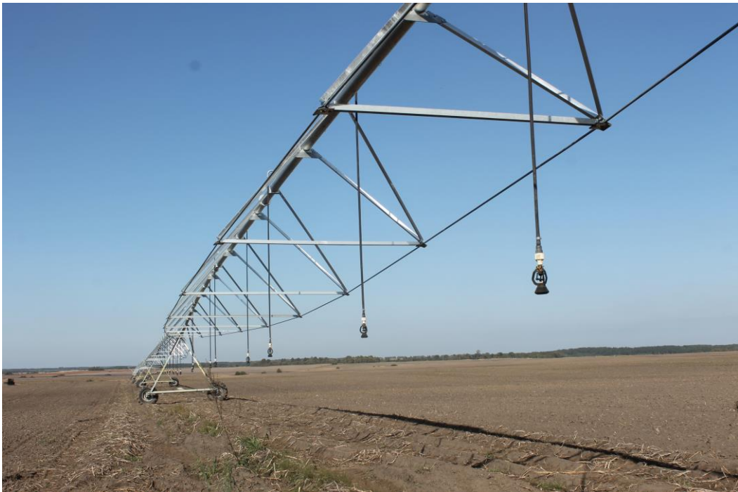
Перемещаемые по высоте форсунки на дождевальной машине Valley
