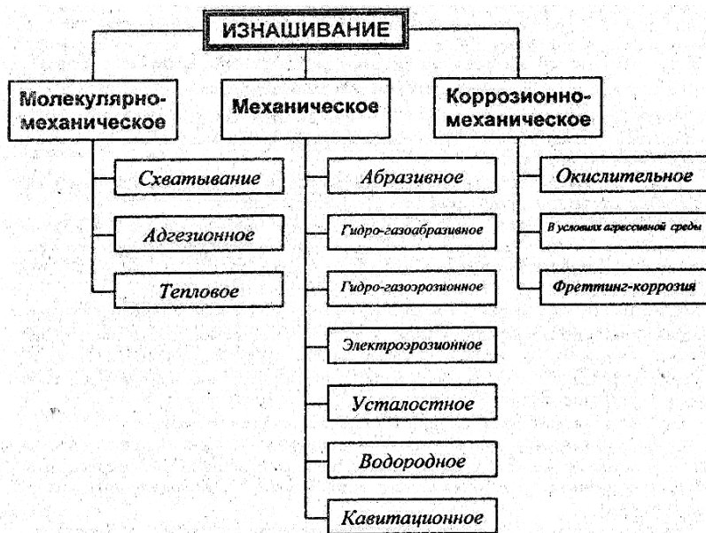
Рис. 2 Классификация видов изнашивания деталей машин
