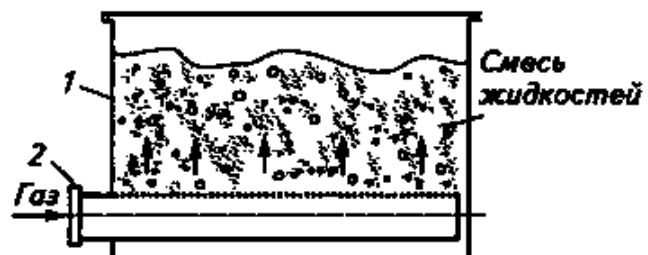
Рис. 7. Схема пневматического смесителя (барботера)
