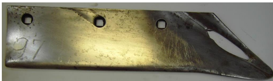
Рисунок 37 – Лучевидный износ, осложненный сквозным протираем лемеха
