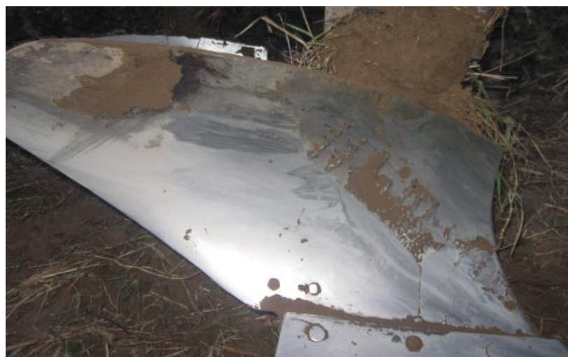
Рисунок 98 – Отвал после истирания наплавленной области
