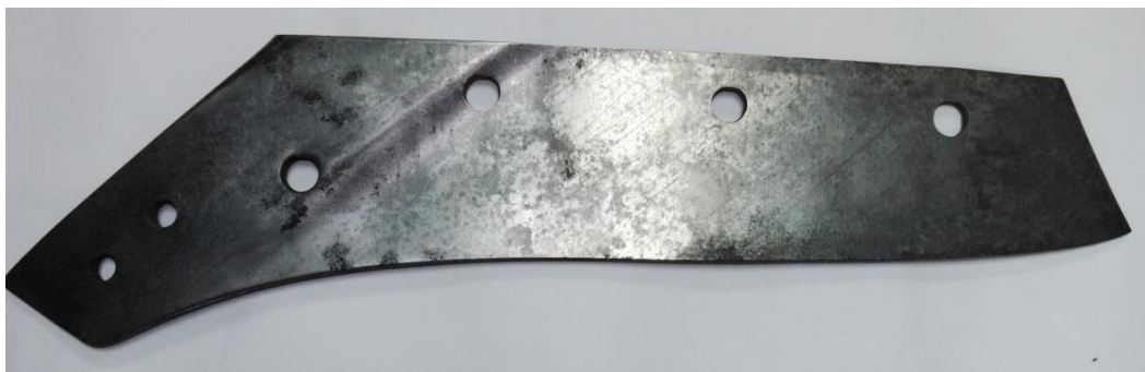
Рисунок 41 – Характерный износ режуще-лезвийной части импортных лемехов на примере лемеха фирмы Kwerneland
