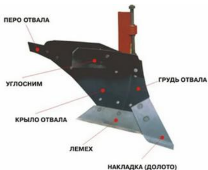
Рисунок 1– Типичный корпус плуга
