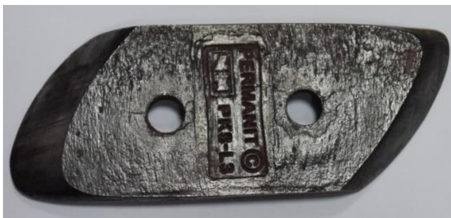
Рисунок 43 – Изношенное долото фирмы Vogel (а – рабочая поверхность; б – тыльная поверхность)
