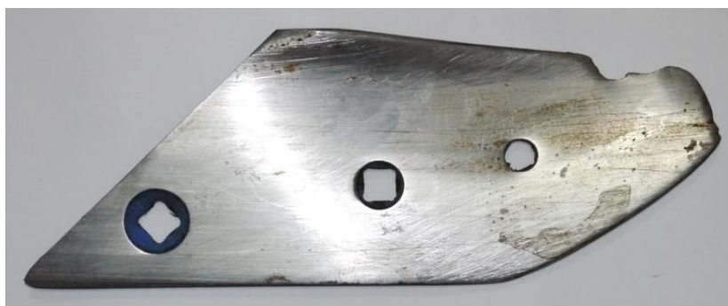
Рисунок 38 – Лучевидный износ долота фирмы Lemken
