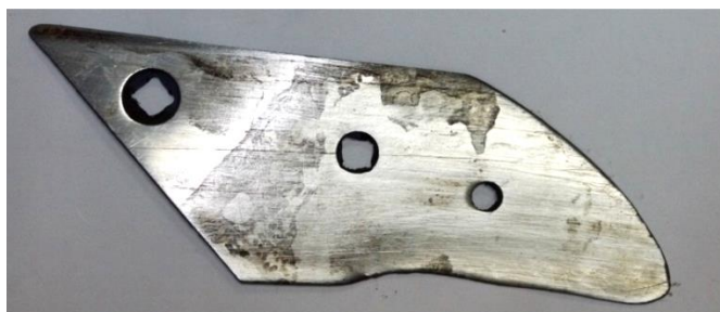
Рисунок 40 – Износ полевого обреза долот производства фирмы Lemken
