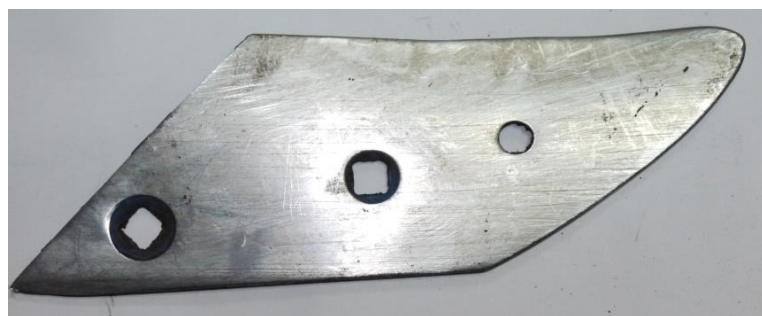
Рисунок 39 – Износ носка долота фирмы Lemken
