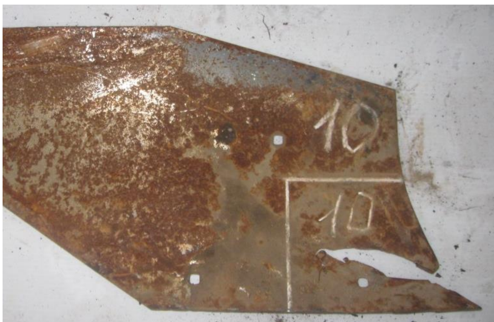
Рисунок 90 – Характерный износ отвала плужного корпуса
