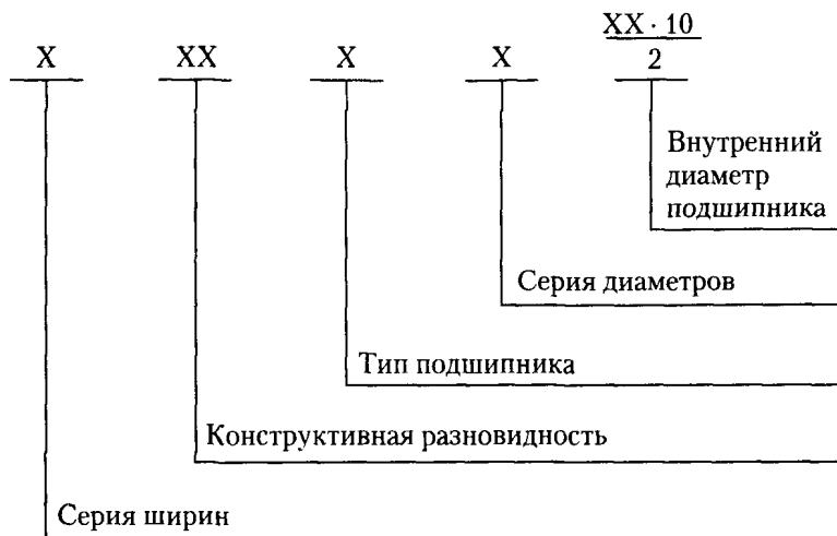
Рис. 10.8. Пример расположения основных знаков условных обозначений подшипников
