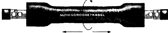
Рис. 12.19. Установка внутренней трубы и направление прогрева
