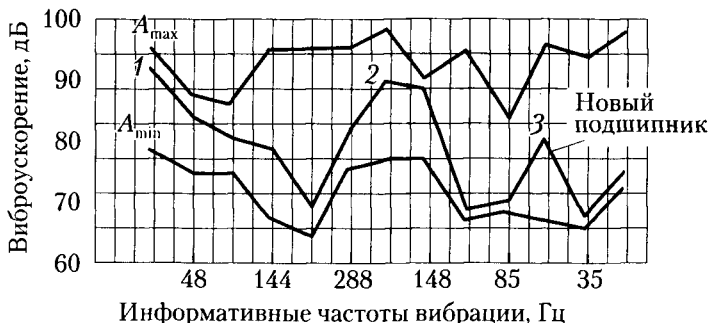
Рис. 10.5. Спектр вибрации нового подшипника качения № 317 с различными дефектами:
