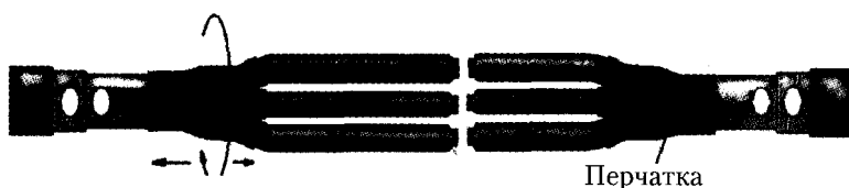
Рис. 12.12. Установка перчатки муфты на жилы кабеля
