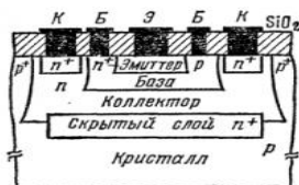
Рис. 4. Интегральный биполярный транзистор, изолированный электронно-дырочным переходом
