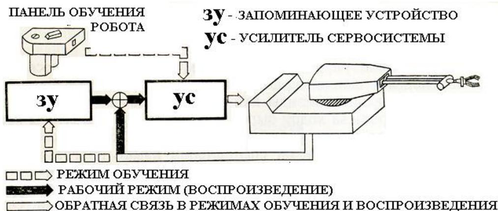
Рис. 3.8. Потоки сигналов при программировании ПР обучением по I-му циклу и управлении им с обратной связью
