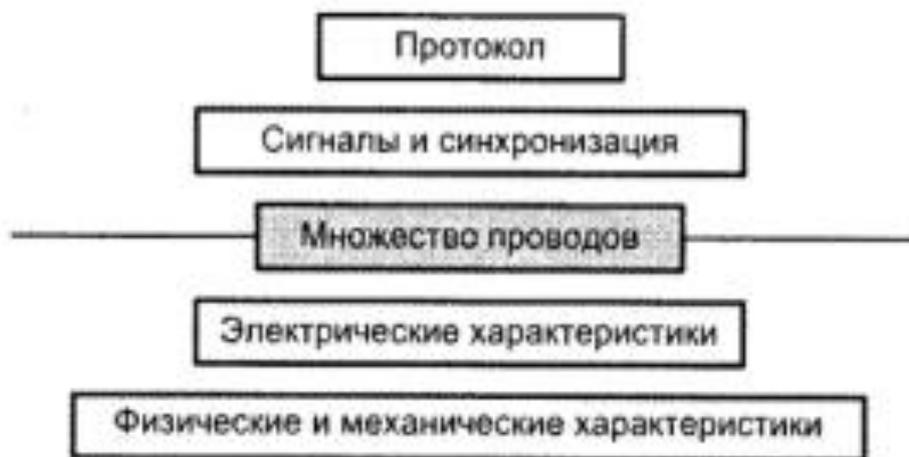
Рис. 4.3. Параметры, характеризующие шину
