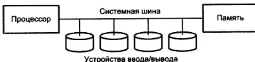
Рис. 4.5. Структура взаимосвязей с одной шиной
