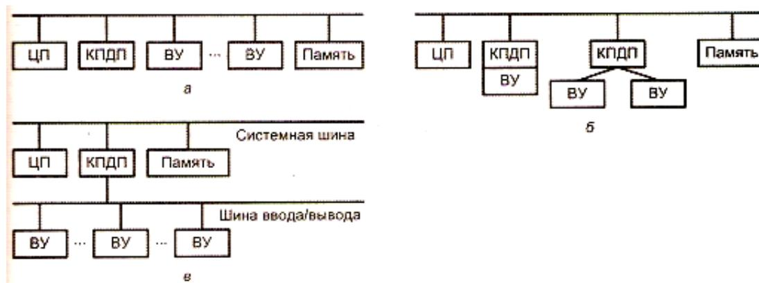
Рис. 8.11. Возможные конфигурации систем прямого доступа к памяти
