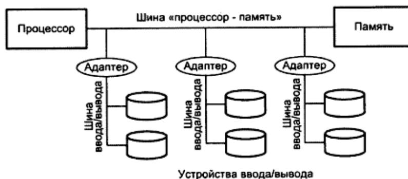
Рис. 4.6. Структура взаимосвязей с двумя видами шин
