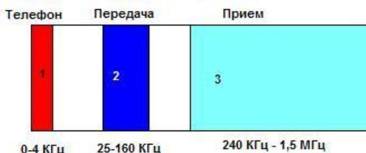
**Рис. 3. Голосовая связь, передача и прием данных по телефонной линии по технологии ADSL**
