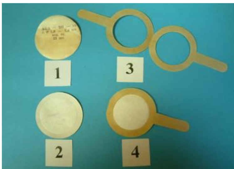
Рисунок 3 – Фильтр АФА-ВП-10: 1 – бумажная подложка, 2 – фильтр, 3 – бумажный держатель для фильтра, 4 – фильтр в бумажном держателе
