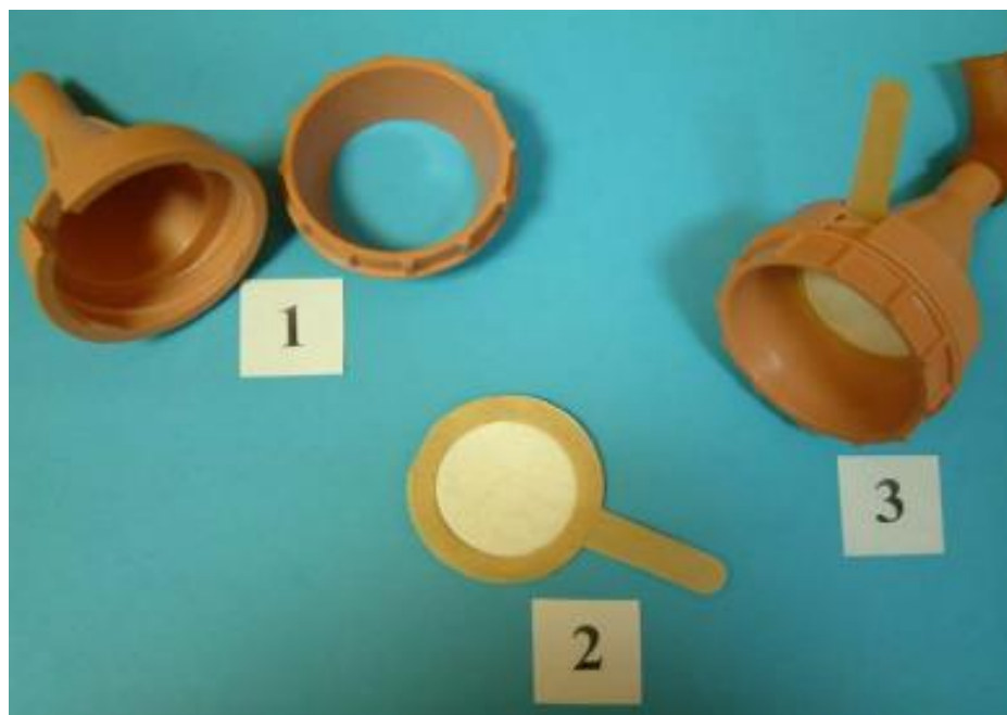
Рисунок 2 – Фильтродержатель ИРА-10: 1 – фильтродержатель, 2 – фильтр АФА, 3 – фильтр в фильтродержателе, соединенном с гибким шлангом
