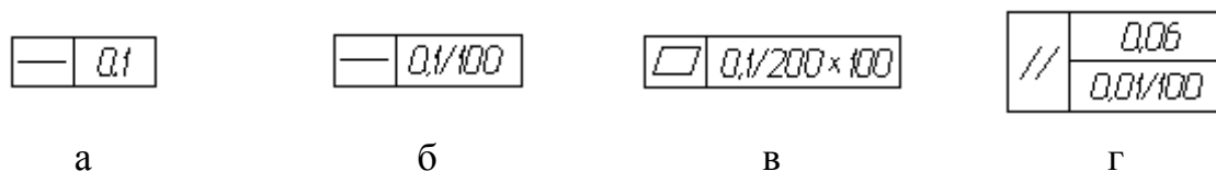
Рисунок 106 - Примеры заполнения второй графы рамки в зависимости от размера поверхности на которую распространяется допуск
