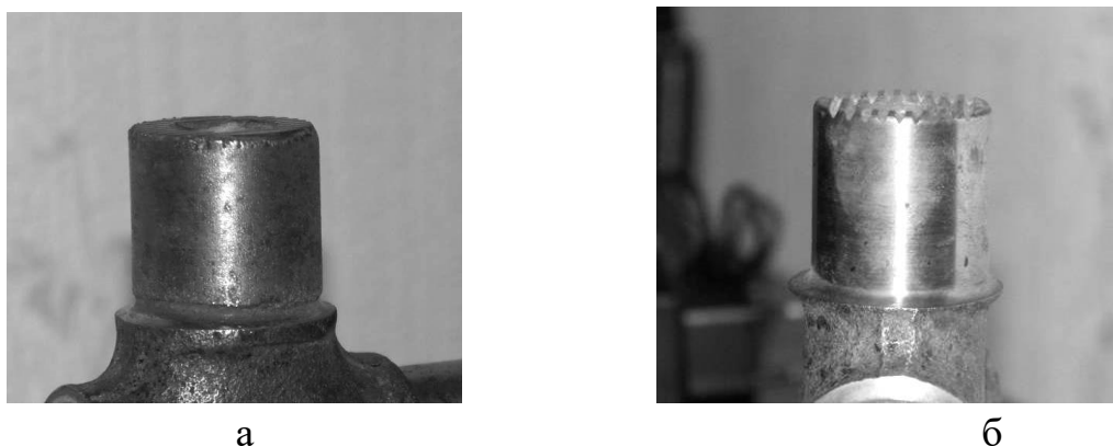
Рис. 5.12. Общий вид шипа восстановленной крестовины до (а) и после (б) финишной механической обработки
