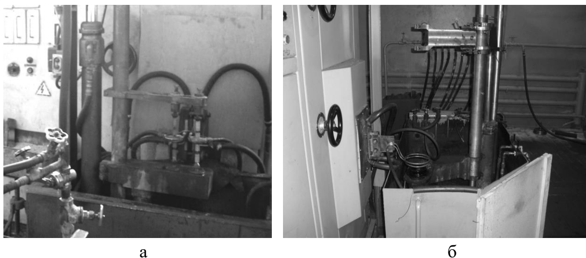
Рис. 5.5. Общий вид установок ТВЧ с приспособлениями для обработки деталей: а) ИЗ-250-66 (ОАО БЭЗРДМ); б) ВЧИ2-100/0,066У2 (ОАО «192 ЦЗЖТ»)
