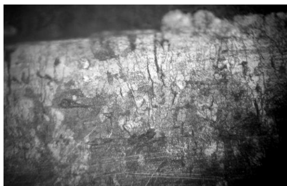
Рис. 4.17. Разрушение КЭП железо-карбид бора при высокотемпературном нагреве (900...1000°C) ( \times 200 )
