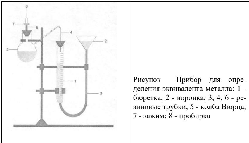
Прибор состоит из бюретки 1 (на 50 мл.) и воронки 2, соединённых между собой резиновой трубкой 3 и заполненных дистиллированной водой. Бюретка резиновой трубкой 4 присоединена к реакционной колбе 5 (колба Вюрца), которая заполнена раствором соляной кислоты и которая в свою очередь резиновой трубкой 6 с зажимом 7 соединена пробиркой 8, куда и помещается навеска цинка.
