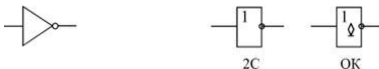
Рисунок 6.4- Условные обозначения инверторов: зарубежные (слева) и отечественные (справа)
