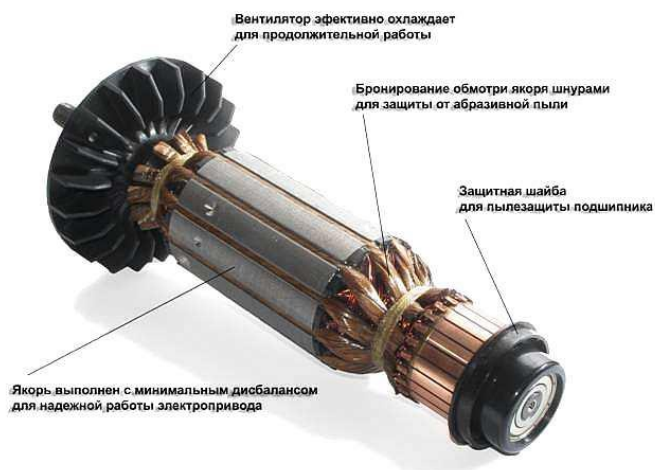
Рисунок 5.4 -Якорь электродвигателя
