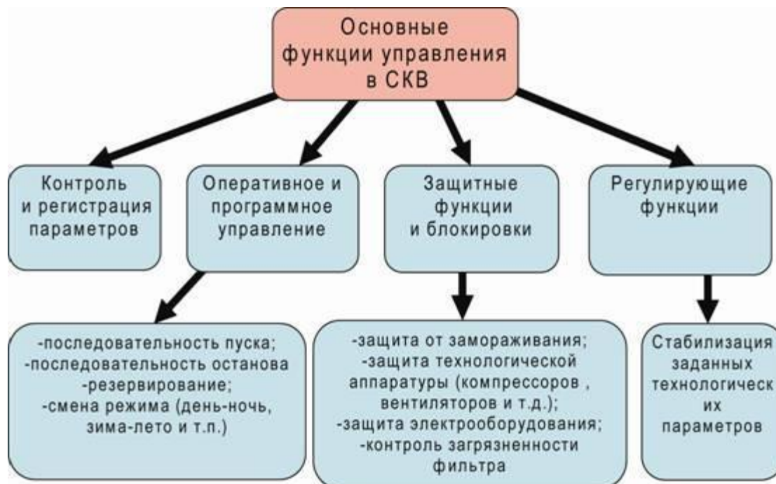
Рис. 3.1. Основные технологические функции управления СКВ.
