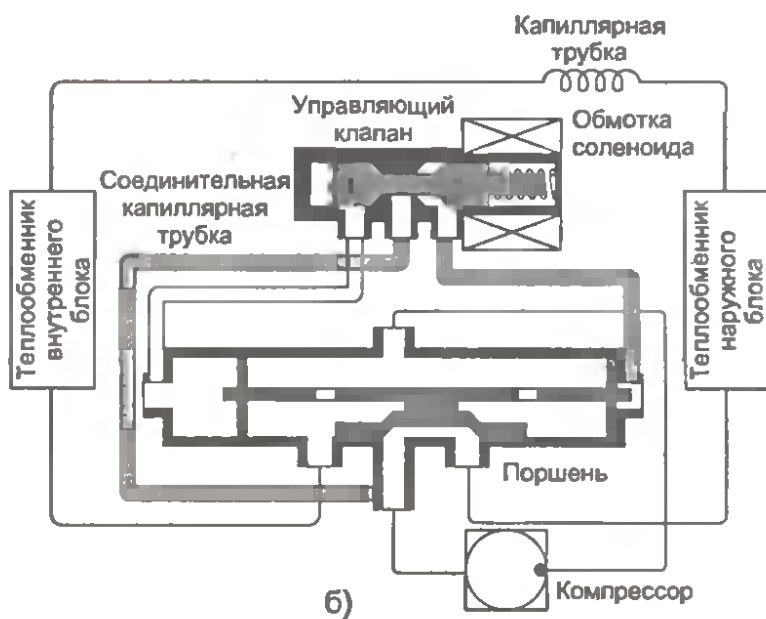
Рис. 2.21. Работа четырехходового клапана: а) в режиме охлаждения, б) в режиме обогрева
