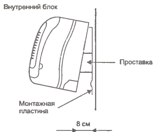
Рис. 5.28. Навеска внутреннего блока сплит-системы (начальная стадия)
