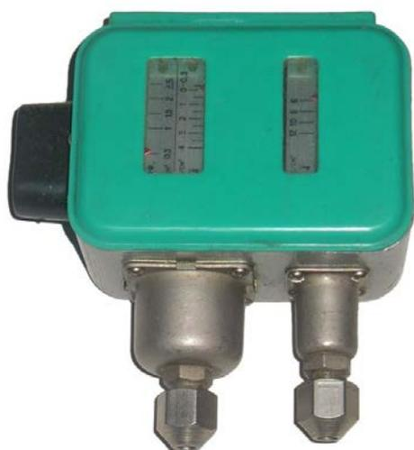
*Рис. 8.4. Реле давления РД-3-01*
