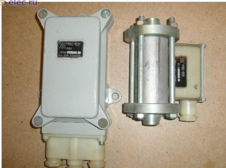
Реле состоит из поплавкового индуктивного датчика (рис. 8.5., справа) и блока полупроводникового усилителя (рис. 8.5., слева). Датчики устанавливают на аппаратах в вертикальном положении и соединяют с ним жидкостным и уравнительным трубопроводами.
