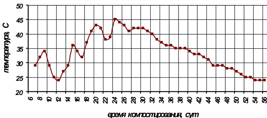
Рисунок 6.11 – Зависимость изменения температуры растительного материала при диагональном размещении термометра
