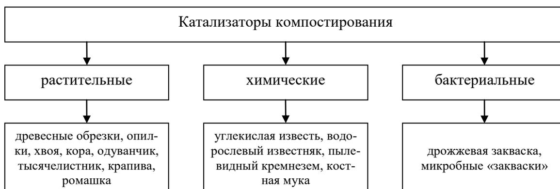
Рисунок 1.3 - Катализаторы компостирования
