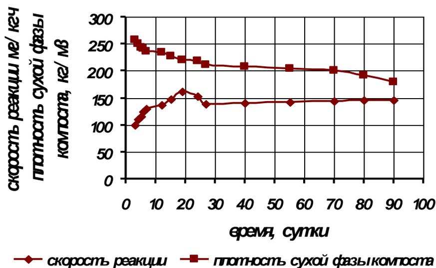
Рисунок 7.24 – Косвенные параметры компостирования
