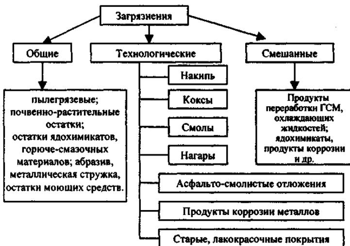
Рис. 2.1 Виды загрязнений тракторов, автомобилей, сельскохозяйственных машин
