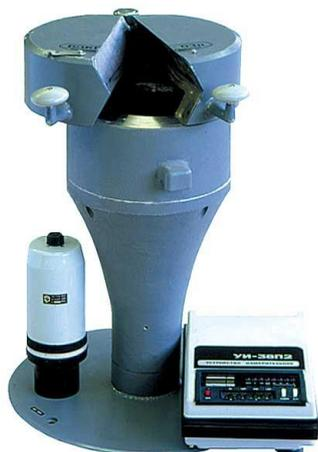
Фотоэлектронный умножитель преобразует сцинтилляции в импульсы электрического тока, а также усиливает этот ток до уровня, поддающегося измерению.
