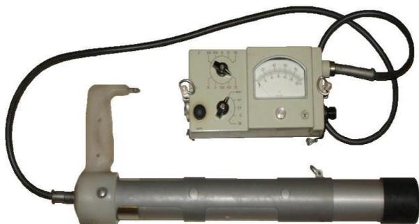
Перед началом работы осмотреть измерительный пункт и блок детектирования на отсутствие механических повреждений.
