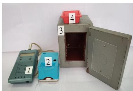
Мюллера, который способен преобразовывать лавину ионов, образованных в счетчике, в электрический импульс. Затем импульс с помощью электрической схемы преобразуется в цифровую информацию, отображающуюся на табло. Для уменьшения влияния внешнего гамма-фона, счетчик размещен в свинцовом домике.
