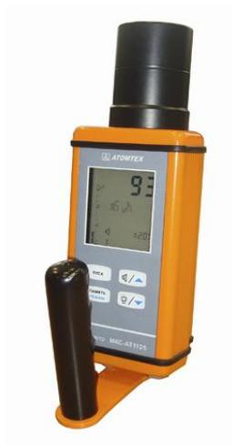
статистической погрешности измерения (%). Новый цикл измерения можно запустить нажатием клавиши включения. При использовании дозиметра радиометра MKS-AT1125 следует выбрать необходимый уровень статистической погрешности измерения (например, 20%) и начинать новый цикл измерения по достижении прибором этого уровня. Выключение прибора осуществляется быстрым трехкратным нажатием клавиши включения.
