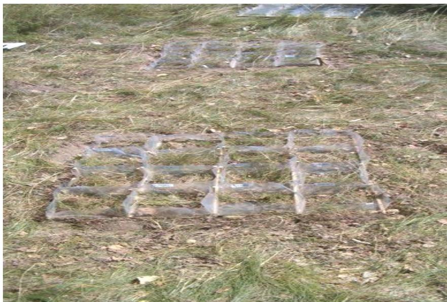
Рисунок 2 – Кассеты ячеек, подготовленные для залива разных количеств нефти на поверхность дерново-подзолистой почвы
