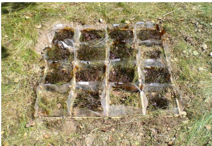
Рисунок 4 – Вид поверхности дерново-подзолистой почвы в модельно-полевом опыте после разлива на неё различных количеств нефти
