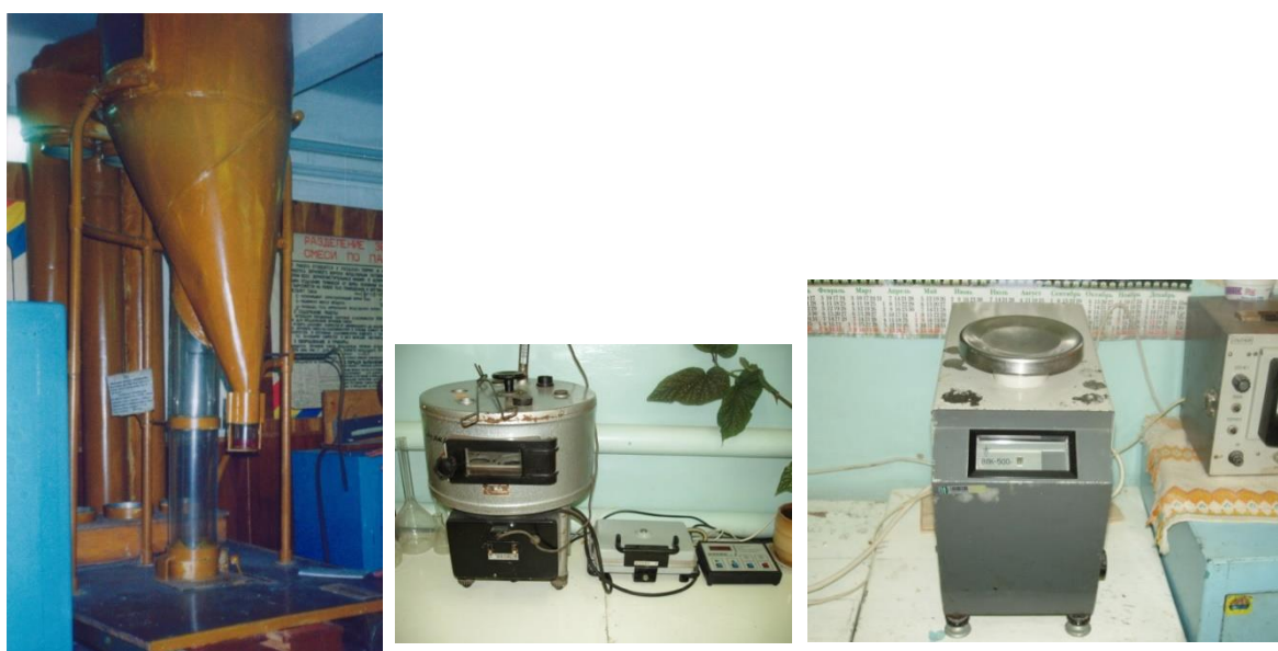
Рис. 2. Парусный классификатор, Электронные весы ВЛК – 500; Сушильный шкаф СВШ – 3 м
