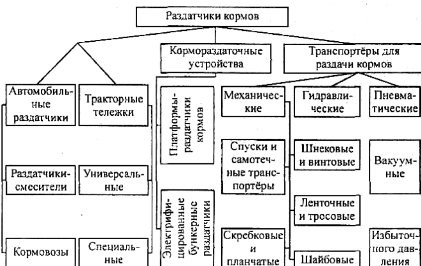
Рис. 23.1. Классификация раздатчиков кормов
