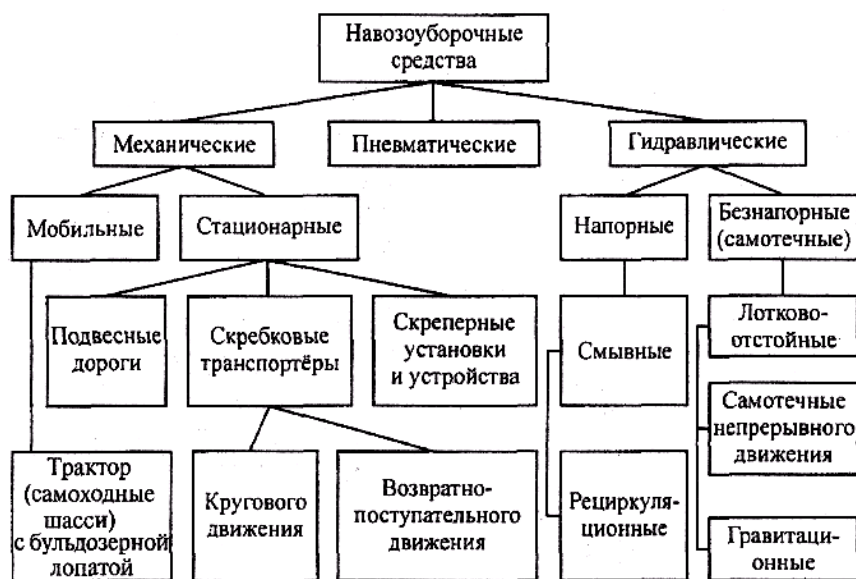
Рис. 25.1. Классификация устройств для удаления навоза из помещений
