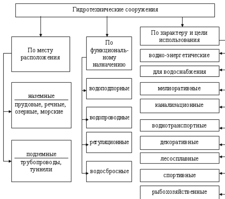
Рисунок 2.2 - Классификация гидротехнических сооружений
