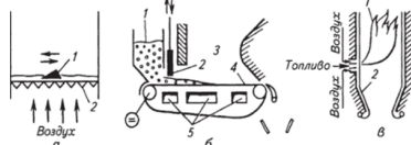
Рис. 8.4. Типы топок: а — слоевая полумеханическая: 1—планка; 2—колосники; б— слоевая механическая: 1 — уголь; 2—шибер; 3—топка; 4—решетка; 5—воздушные короба; в — камерная: 1—факел; 2—экран
