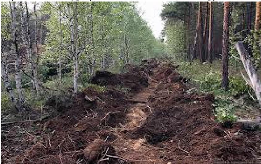
Рисунок 12 – Минерализованная полоса, проложенная плугом ПКЛ-70
